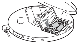
Sätt först i \ominus -änden (för båda batterierna).
