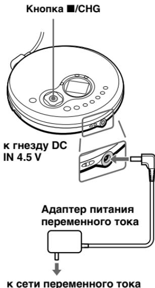
Проигрыватель подзаряжает батарейки. Последовательно загорятся сегменты индикатора . Когда батарейки полностью подзарядятся, индикатор погаснет.
