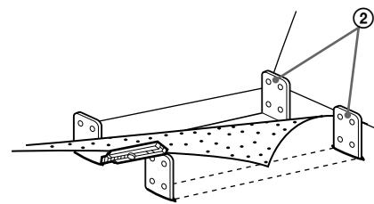
**6** Skruva fast högtalarlädan vid golvbeslagen ② med de medföljande skruvarna ①. Säkra den sedan med hjälp av det medföljande bandet ⑥ som du fäster vid bilen (t.ex. runt baksätes ryggstöd).
