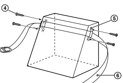
**B** Skruva fast högtalarlädan vid golvbeslagen ② med de medföljande skruvarna ①.
