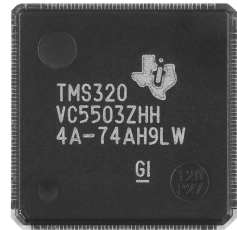
DSP utilizado en la unidad MDR-NC500D
