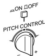
Drücken Sie PITCH CONTROL in Stellung ON und drehen Sie den Regler nach rechts (zum Erhöhen der Bandlaufgeschwindigkeit) oder nach links (zum Verringern der Geschwindigkeit). Eine Feineinstellung ist während der Wiedergabe mit Deck A und beim Überspielen mit Normalgeschwindigkeit möglich, nicht jedoch bei RMS-Wiedergabe oder RMS-Überspielen.
