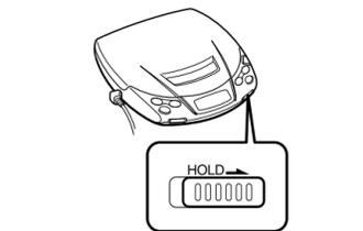
Schieben Sie HOLD in Pfeilrichtung. Wenn Sie dann eine Taste drücken, erscheint "Hold" im Display, und die Taste bleibt ohne Wirkung.
