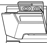
**3** Appuyez de façon répétée sur DIRECTION pour sélectionner
