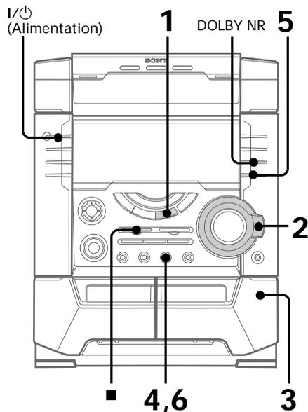
**1** Appuyez sur TUNER/BAND pour sélectionner la gamme souhaitée.
