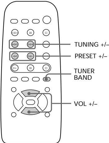
**1** Appuyez de façon répétée sur TUNER/BAND jusqu'à ce que la gamme souhaitée apparaisse sur l'afficheur.
