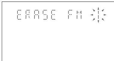
2 Tournez SHUTTLE jusqu'au déclik pour sélectionner le numéro de présélection à effacer.
