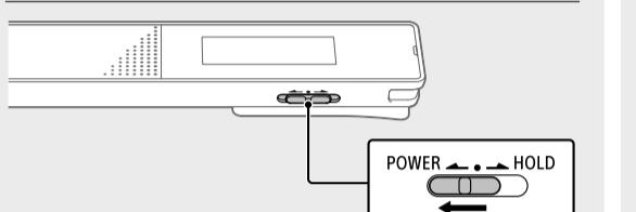
Deslice y sujeté el interruptor POWER•HOLD en el sentido de "POWER" hasta que aparezca la ventana de visualización.
